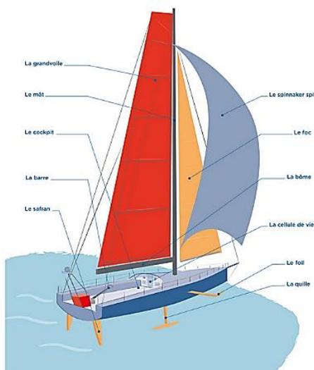
**Mât :** D'une hauteur maximale de 29m, ce « poteau » permet de hisser les voiles.
